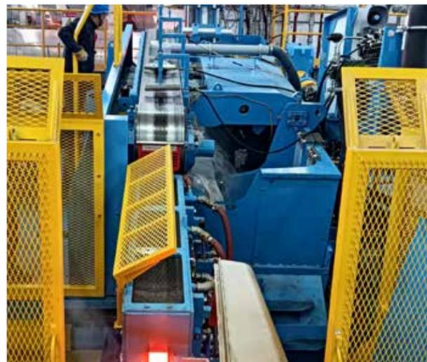
Bild rechts - **HICON/H<sub>2</sub>**® vertikale Blankglühlinie für kaltgewalzte Bänder aus Kupfer und Kupferlegierungen
