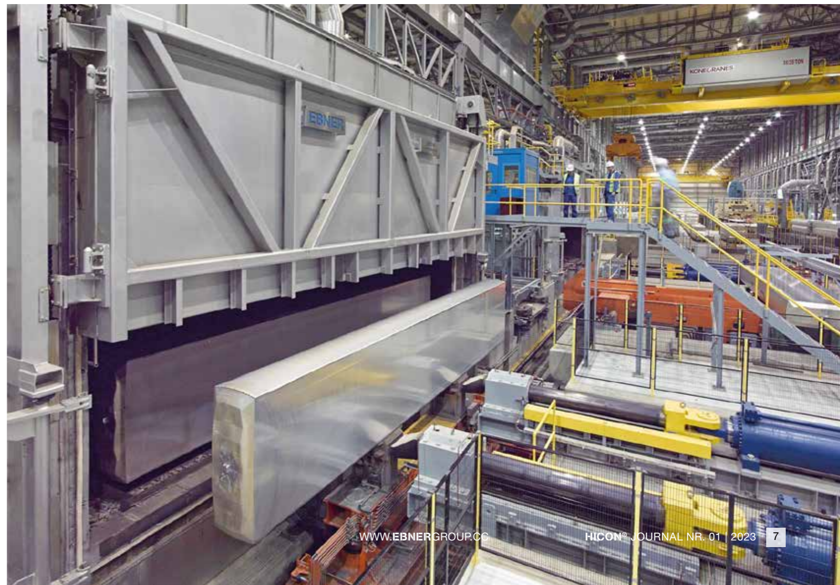
EBNER Stoßofen (Ofeneingang) mit sehr langen Walz-Barren für einen modernen Produktionsbetrieb
