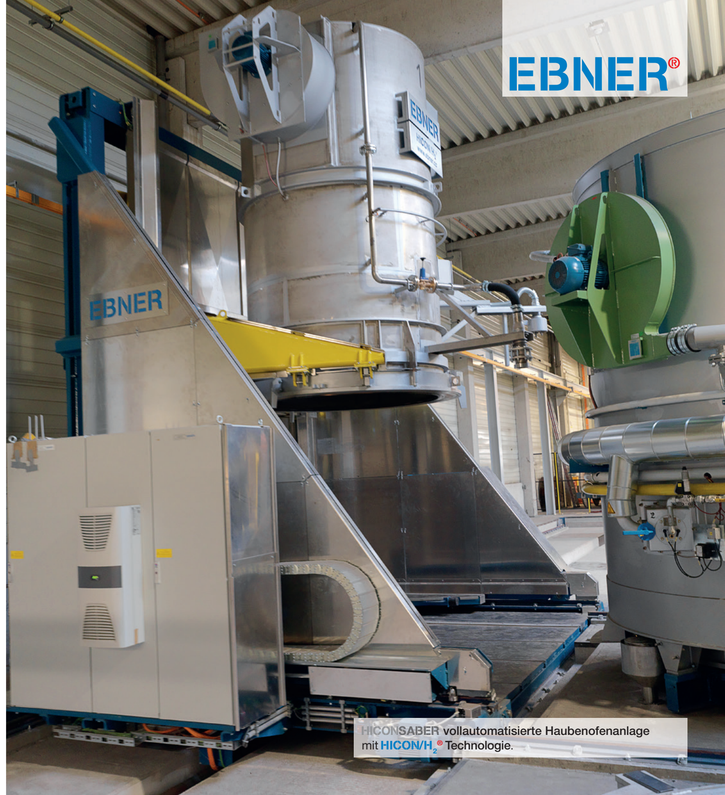
Einsetzbar zur Wärmebehandlung von Halbzeug aus Stahl, Buntmetall und Aluminium.
