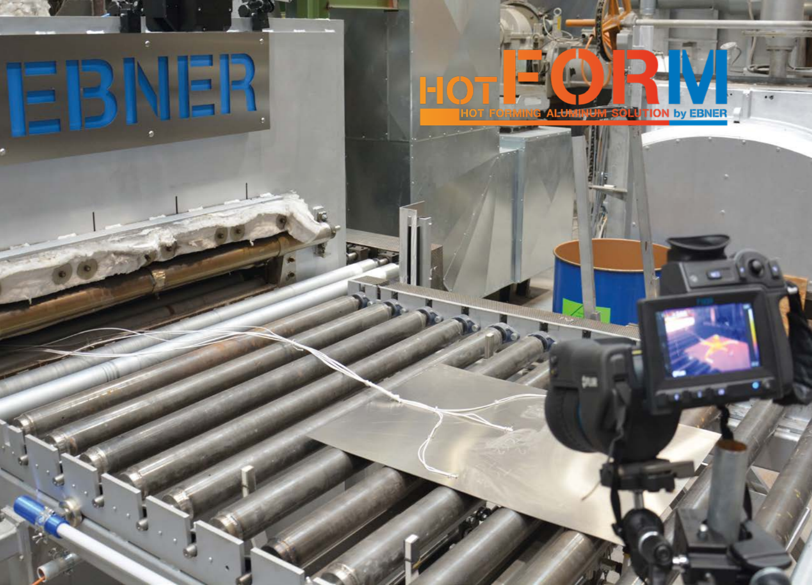
艾伯纳实验室内展示的艾伯纳 HotForm & ITL 铝板料热成型
