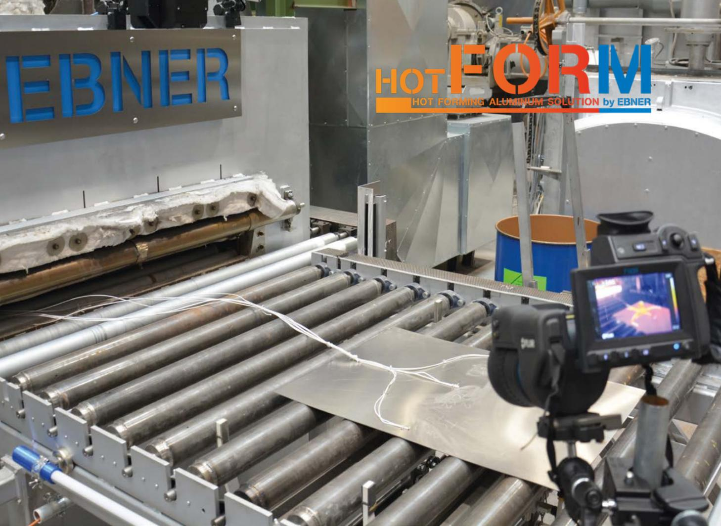
Vorführung der **EBNER** HotForm & ITL Warmumformung von Aluminiumplatten im **EBNER** Labor
