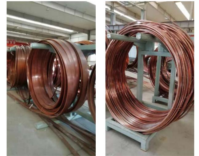
Typische Produkte wie Draht- und Rohmaterial für Stromschienen
