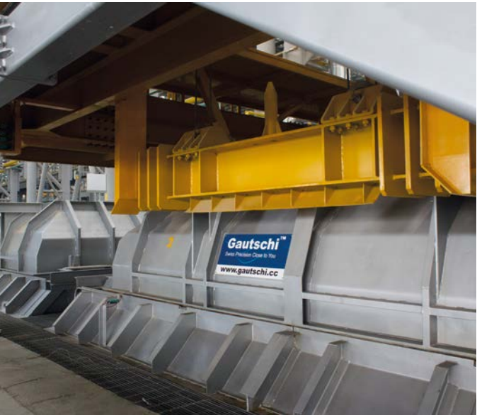
坑式炉，适用于铝轧制铸锭
