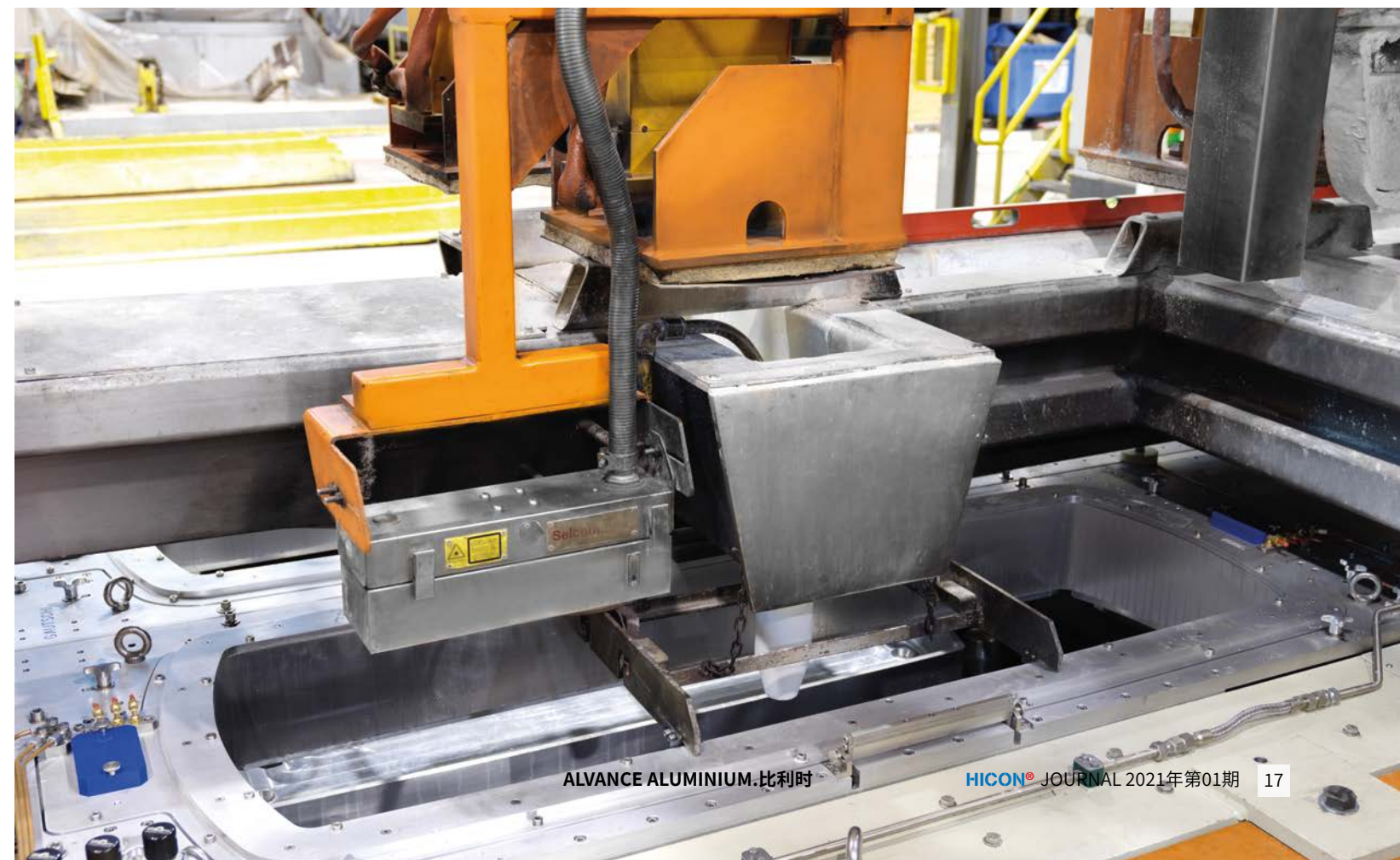
带金属流控制的铸造清洗机以及液态金属水平测量装置
