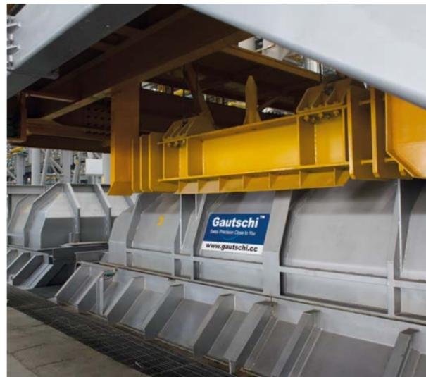
坑式炉，适用于铝轧制铸锭
