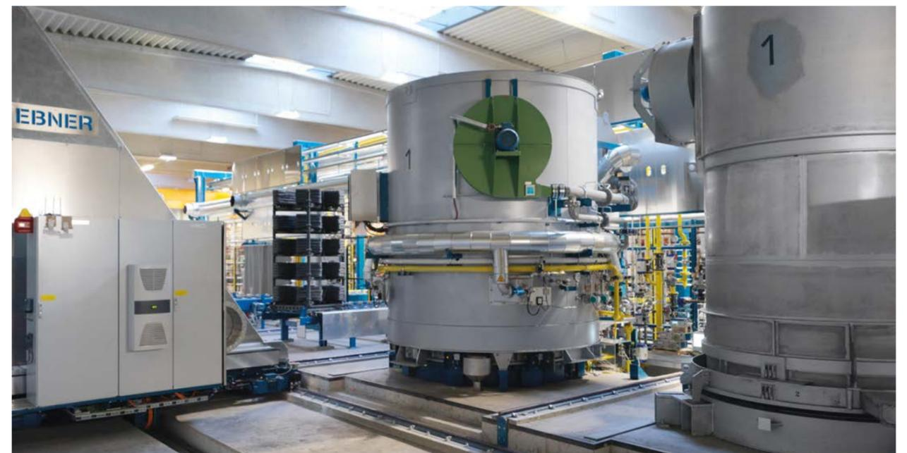
除了在特殊装料篮中退火的LWC线卷外，还可采用大型钢桶为设备装料，最大可装2.5吨铜产品。
