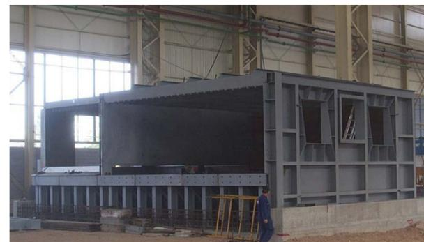
145吨双室熔炼炉
