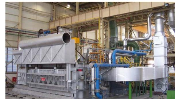
145吨双室熔炼炉
