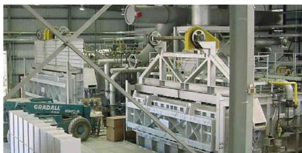
50吨回转废钢熔化保温炉
