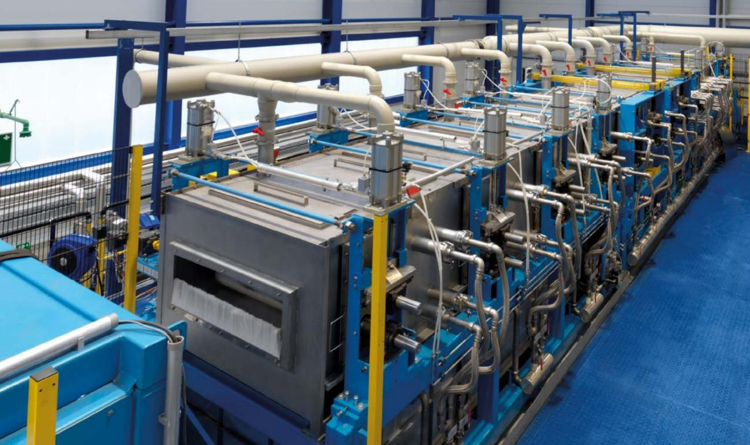
艾伯纳带材清洗装置，配备带材从清洗区至干燥装置的输送装置
