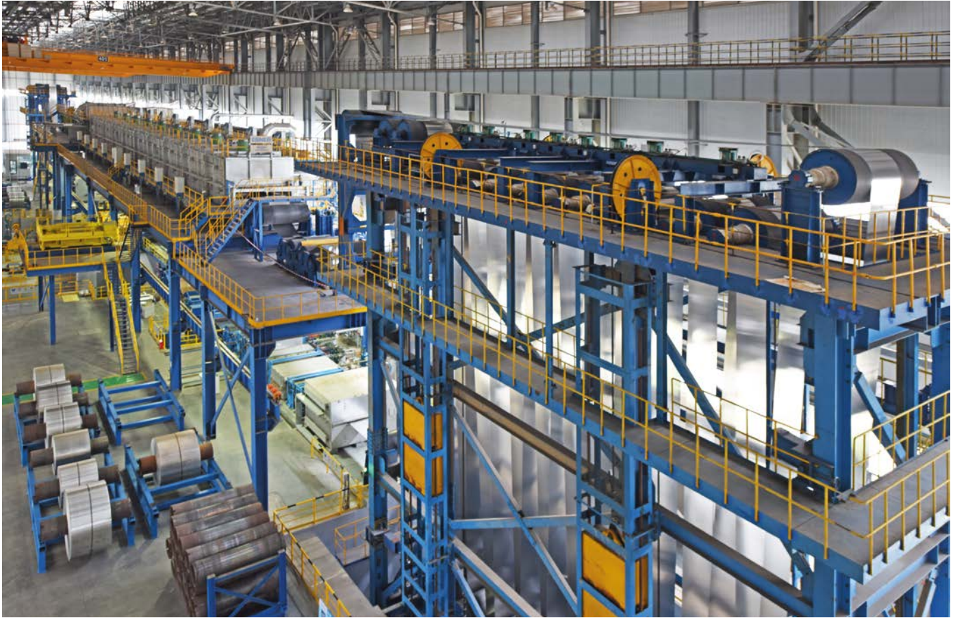
HICON® 气垫炉，适用于铝及铝合金材料的处理
