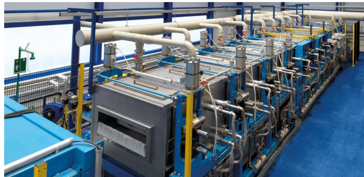
艾伯纳带材清洗装置，配备带材从清洗区至干燥装置的输送装置
