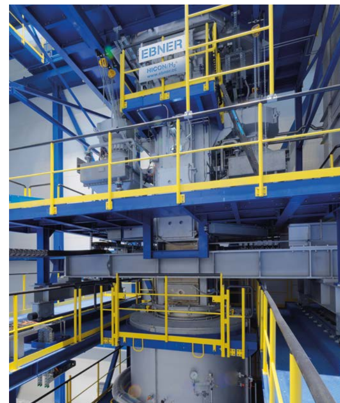
高温炉2号至 HICON/H 2 喷射冷却区输送
