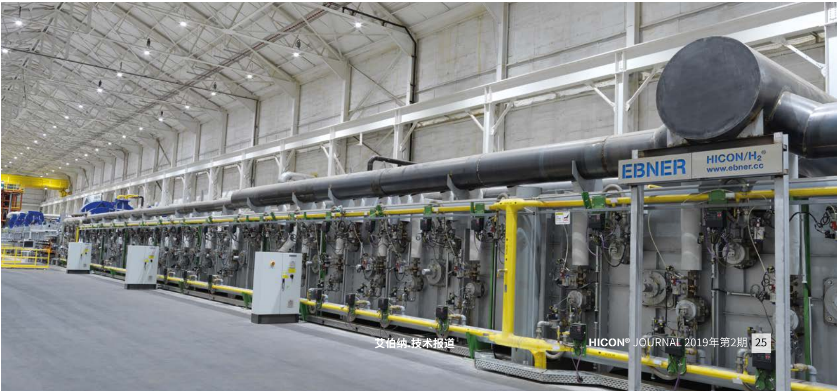
卧式辐射管加热连续式炉,采用氢气气氛
