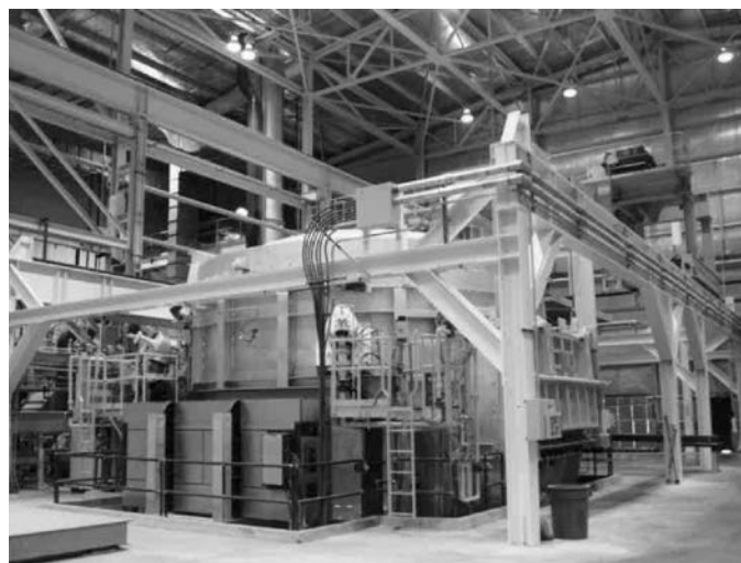
第一台TRTC熔炼炉, 配备ABB的侧装搅拌机 客户 - Kaiser Sierra Micro Mills/内华达州 1996年
