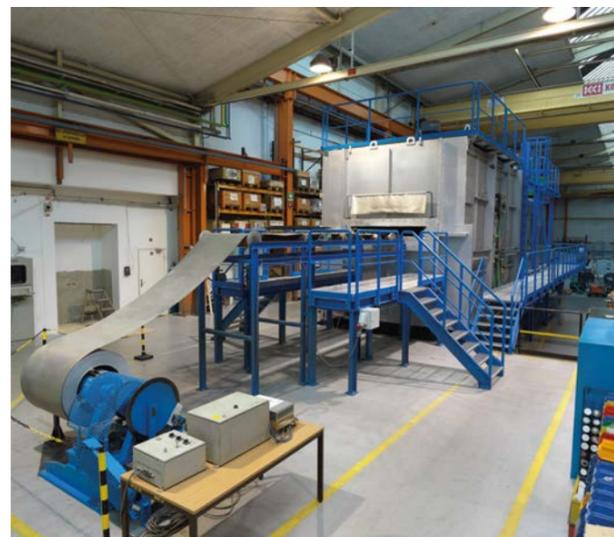
气垫炉, 炉子入口端
