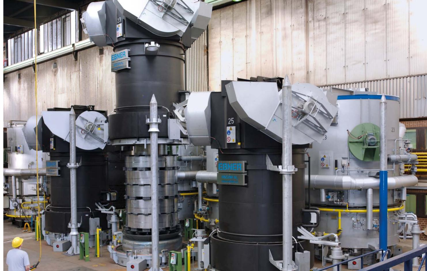
艾伯纳 HICON/H<sub>2</sub> 罩式退火炉设备
