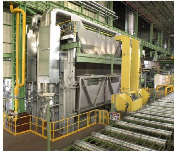
诺贝丽斯在韩国Taihan Aluminium的推进式炉一，出口端视图
