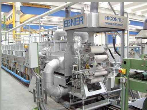
Перевод действующего оборудования с закалкой в масляной ванне на оборудование с технологией закалки HICON/H 2 Q для закалки на мартенсит полос из нелегированной и низколегированной углеродистой стали
