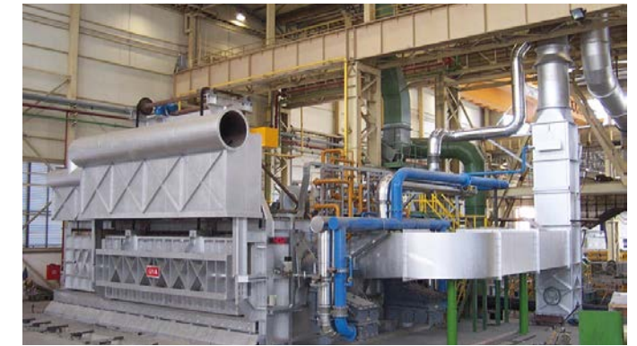
Der fertige 145 t Doppelkammer-Schmelzofengehäuse
