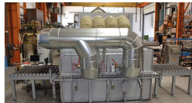
Prototyp eines Rollenherdofens für die Warmumformung von Aluminium
