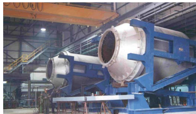
Das erste im Bau befindliche Drehofenprojekt mit 9 t Kapazität
