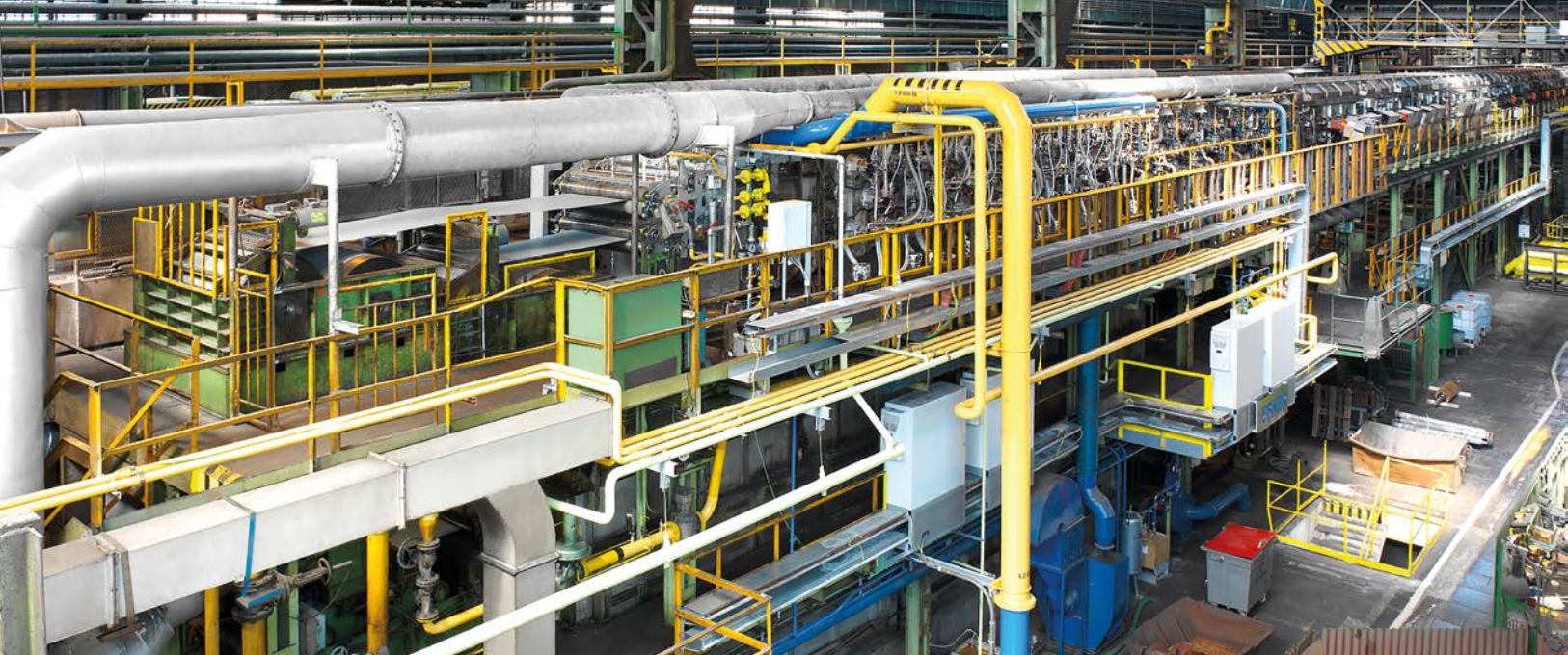
HICON/H 2 Entkohllinie bei GO Stalprodukt, Frydek-Mistek, Tschechien
