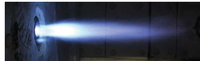
ECOBURN Brenner bei einem Versuch in der Brennkammer
