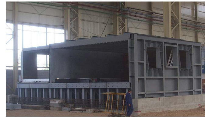
Ein 145 t Doppelkammer-Schmelzofengehäuse während der Montage
