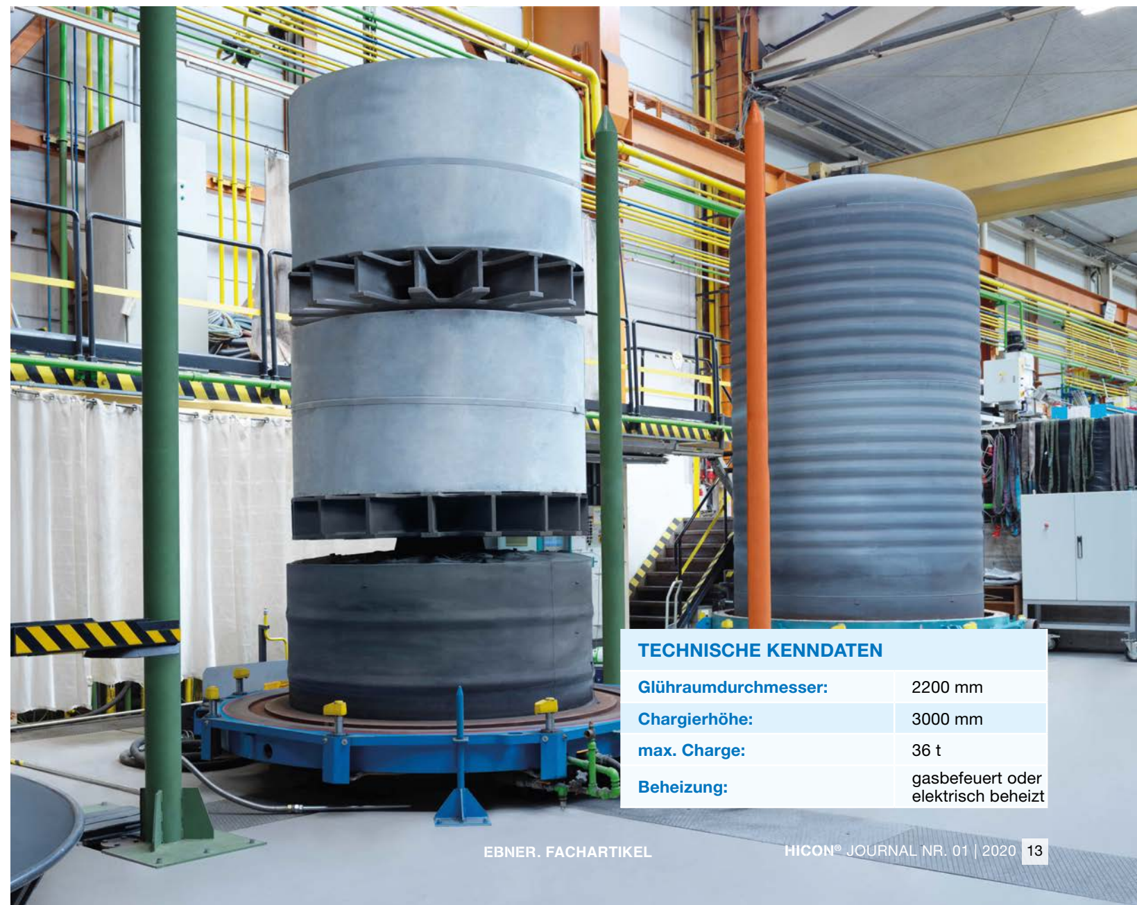
HITT Hochtemperaturhaubenofen (HBAF) beladen mit 2 GO Coils
