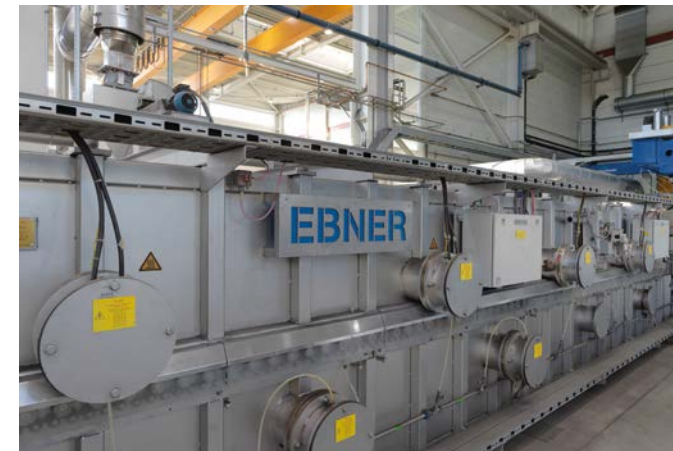
Presshärte Demolinie bei MAGNA in Weikersdorf
