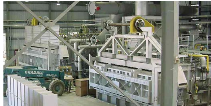
Ein 50 t schwenkbarer Schrottschmelz- und Warmhalteofen
