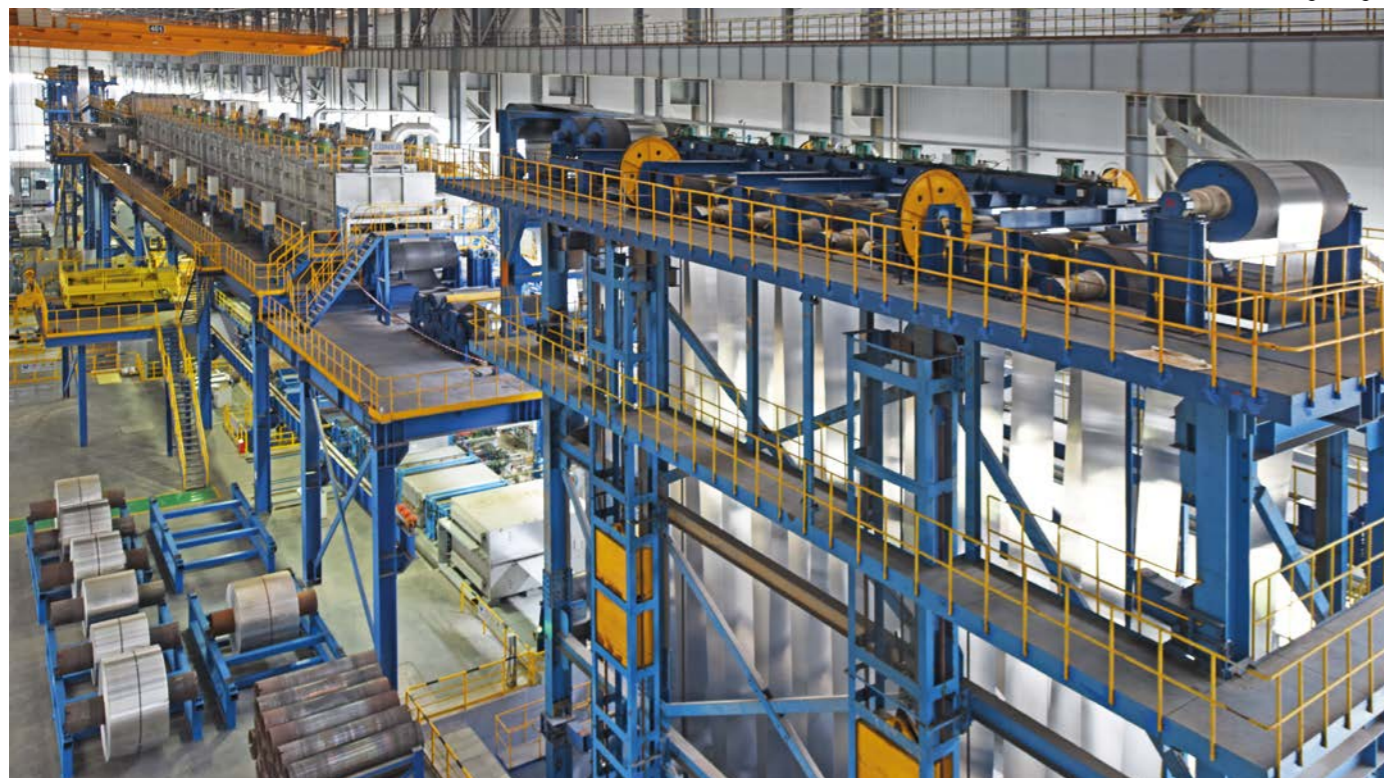
HICON ® Bandschwebeanlage zum Vergüten und Glühen von Bändern aus Aluminium und Aluminiumlegierungen
