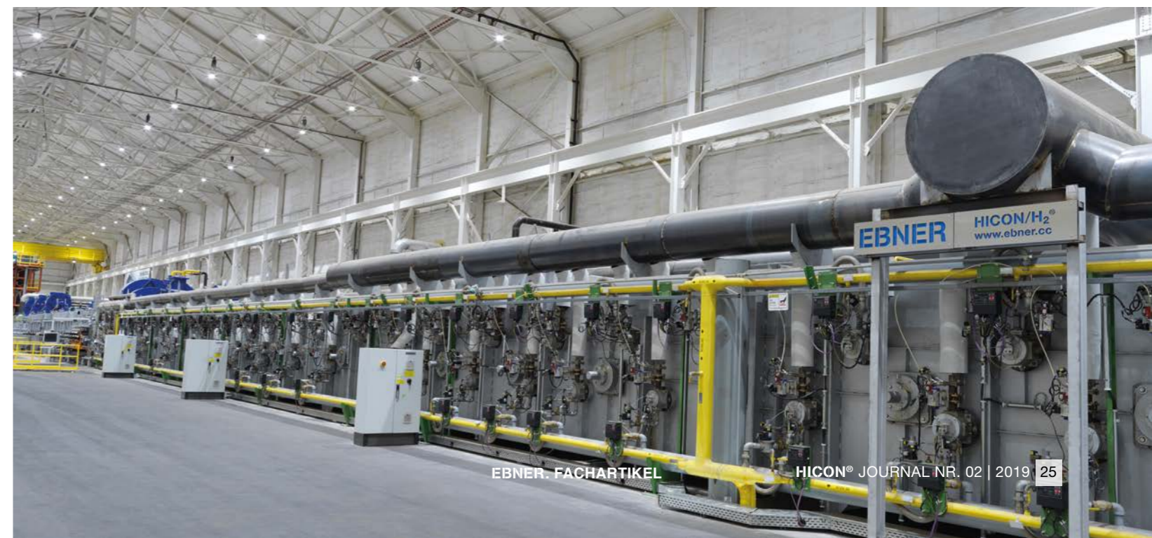
Horizontaler strahlrohrbeheizter Durchlaufofen mit Wasserstoffatmosphäre
