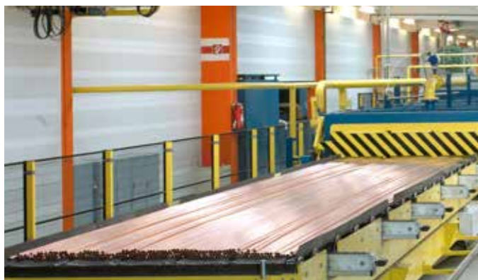
Rollenherdofen Anlage für Kupferrohre- und stangen
