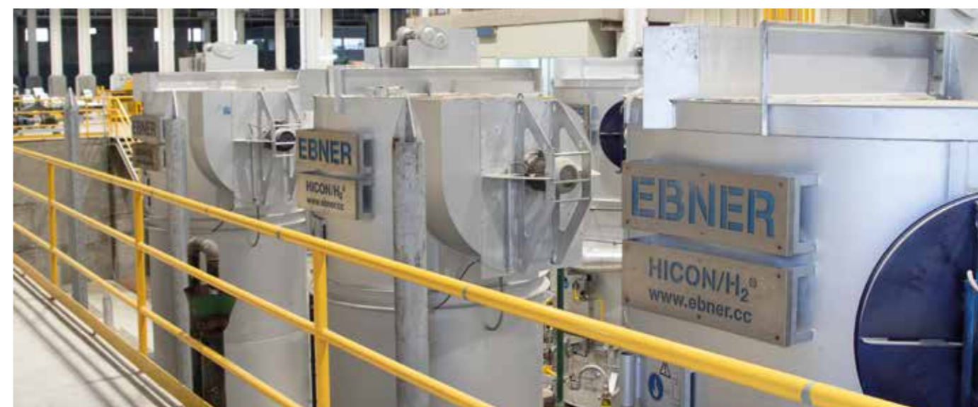
Ansicht Heizhauben und Kühlhauben
